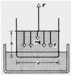
2. Otro método para determinar la tensión superficial de un líquido es encontrar la fuerza necesaria para levantar y sacar un anillo de alambre de la superficie del líquido como se muestra en la figura de la izquierda. Si se utiliza un anillo de 5,0 cm de diámetro, ¿cuál es la tensión superficial del líquido si, además del peso del anillo, se requiere una fuerza de  $2,3 \times 10^{-3}$  N para sacarlo del líquido?
